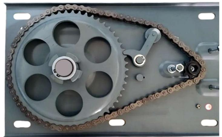
En algunos modelos, está instalado un **gatillo anti-caída**, en el caso que la cadena de transmisión se corte, el mismo, por intermedio de un resorte, trava de manera inmediata el movimiento del piñón.
